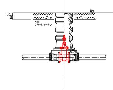
埋設部空気弁対策工事図面
